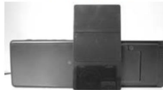
不具合発生プレートは赤外線非透過 (または光量が低下)
