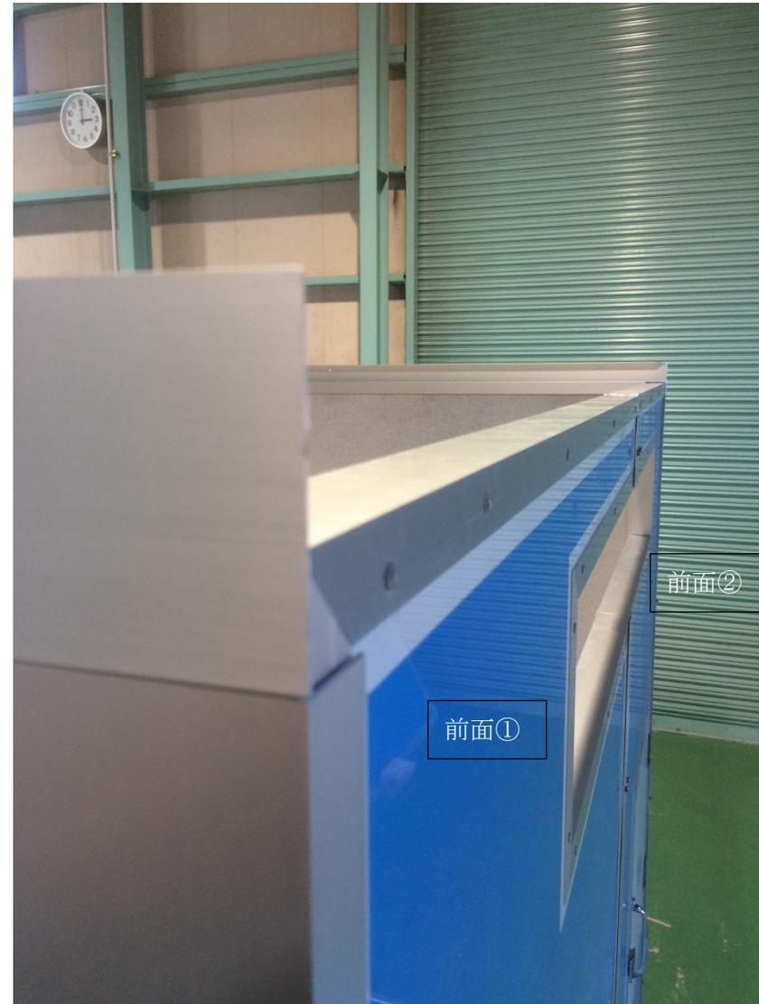
9. 天板②を写真のように前面上部からスライドさせるようにはめ込み、ビス留めします。(パネル向きはビス留めできる方が奥になります)
